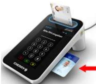
Hier wird der eHBA in den Slot an der rechten Seite gesteckt.
